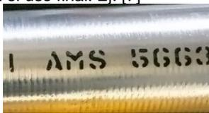
Figura 7. Grabado de los componentes fabricados bajo la norma AMS 5662
