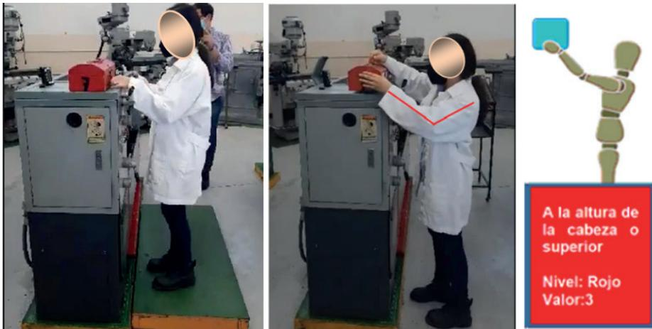
Figura 4. Muestra las condiciones manejo en el torno 7.
